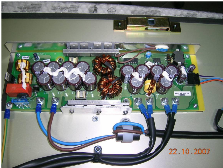
Slika 1. Napajanje displeja sa diskretnim komponentama
