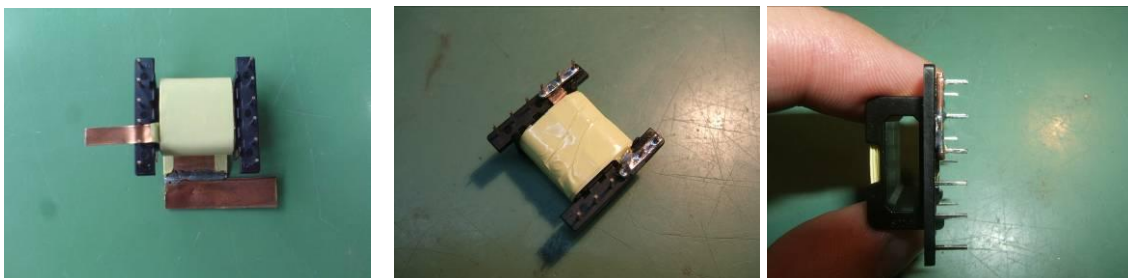
Slika 4. Tehnologija motanja induktivne komponente (5V, 40A)
