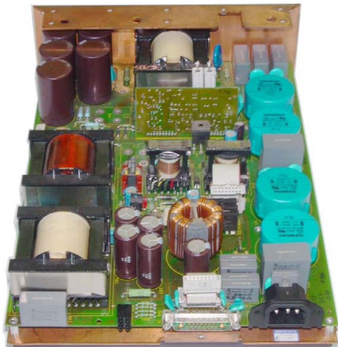
Slika 3. Izgled ispravljačkog modula sa prirodnim hlađenjem
